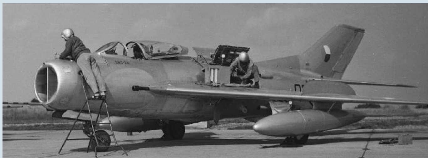
Pohled na uložení dvou motorů RD-9B (M-09) MiGu-19S ovzletovém výkonu 31,88 a maximálním výkonu 25,51kN. Dole žánrový pohled na běžnou rutinu na letišti Aera Vodochody.
